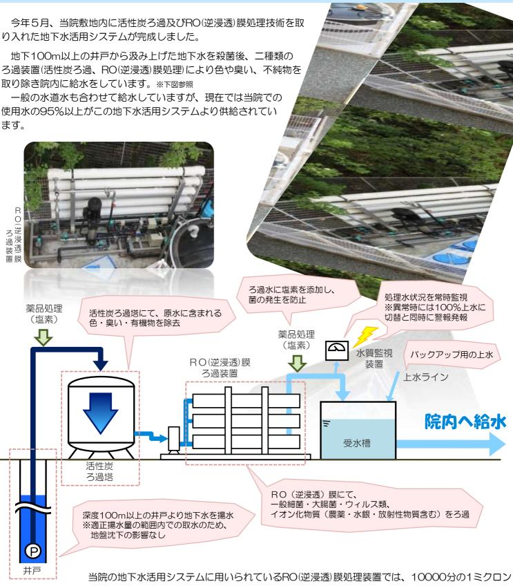
(ミクロン=1ミリメートルの1000分の1の長さ=1マイクロメートル)という非常に細かい穴の膜を通し、人工的に圧力をかけて不純物を取り除きます。水道法による水質基準を満たすことはもちろんですが、一般細菌、大腸菌、ウイルス類、イオン化物質(農薬・水銀・放射性物質を含む)を99%以上ろ過することができるので、非常に安全性の高い水を供給することが可能です。またこのシステムは災害時にも使用することができるので、自家
