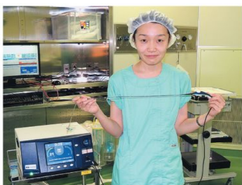
ラジオ波治療の専用カテーテルを手にする磯貝医師。左下にあるのが高周波を発生する本体装置
