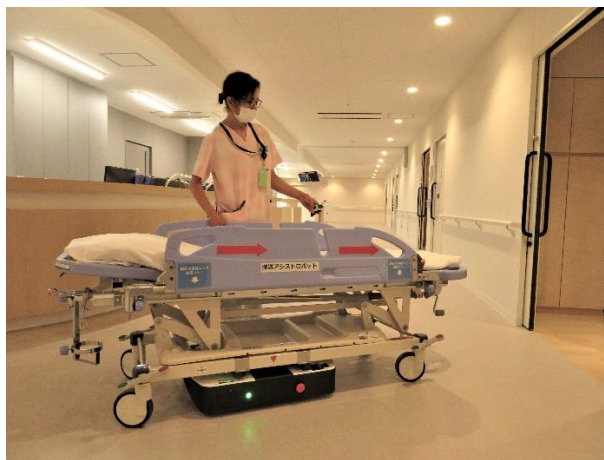
同ロボットを取り付けたストレッチャー （湘南鎌倉総合病院で撮影。写真では看護補助者が左 手でリモコン操作し、ストレッチャーを移動中）
